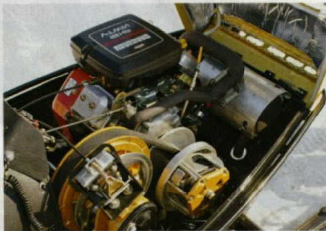
Двухцилиндровый V-образник от Briggs&Stratton в штатной комплектации один в один состыковался с «тайговским» вариатором.
